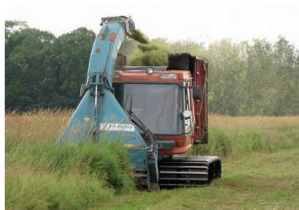
Abb. 18: Erntemaschine für Feuchtgrünland, basierend auf einem Pisten-Bully
